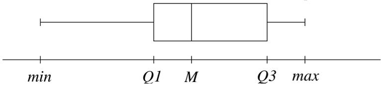
Le diagramme en boîtes est représenté sur une échelle horizontale. Les points sont marqués à  $min$ ,  $Q_1$ ,  $M$ ,  $Q_3$  et  $max$ . Une boîte s'étend de  $Q_1$  à  $Q_3$ , avec une ligne verticale à  $M$ . Des lignes horizontales (moustaches) s'étendent de  $min$  à  $Q_1$  et de  $Q_3$  à  $max$ .
